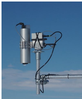
HYPSTAR® system [Kuusk et al., 2024] 380-1700nm, 3-10nm FWHM
